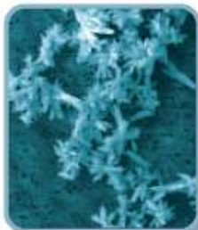
Kalkkrystaller sammenklynget i ubehandlet vand
