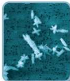
Kalkkrystaller behandlet med AMTech 100 ®
